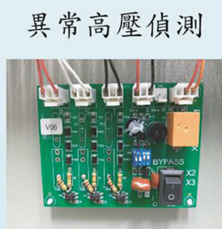
當內部有突波高壓產生時，即啟動旁路系統
